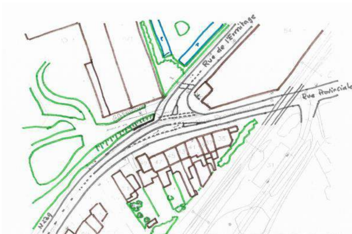
Figure 30 : option de réaménagement avec voie de tourne-à-gauche
